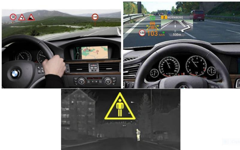
Figure 2 - Représentation des différents systèmes d'aide à la conduite [7]
