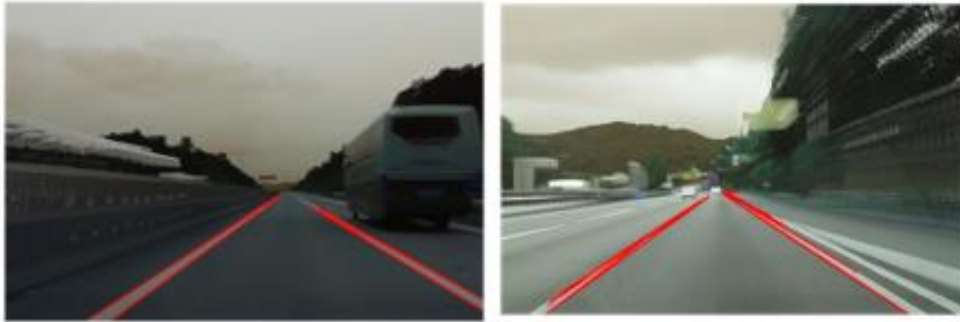
Figure 31 - Voies détectées à l'aide de transformée de Hough probabiliste.
