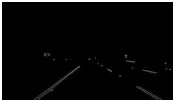
Figure 9 - Résultat du détecteur de contour Canny [56]
