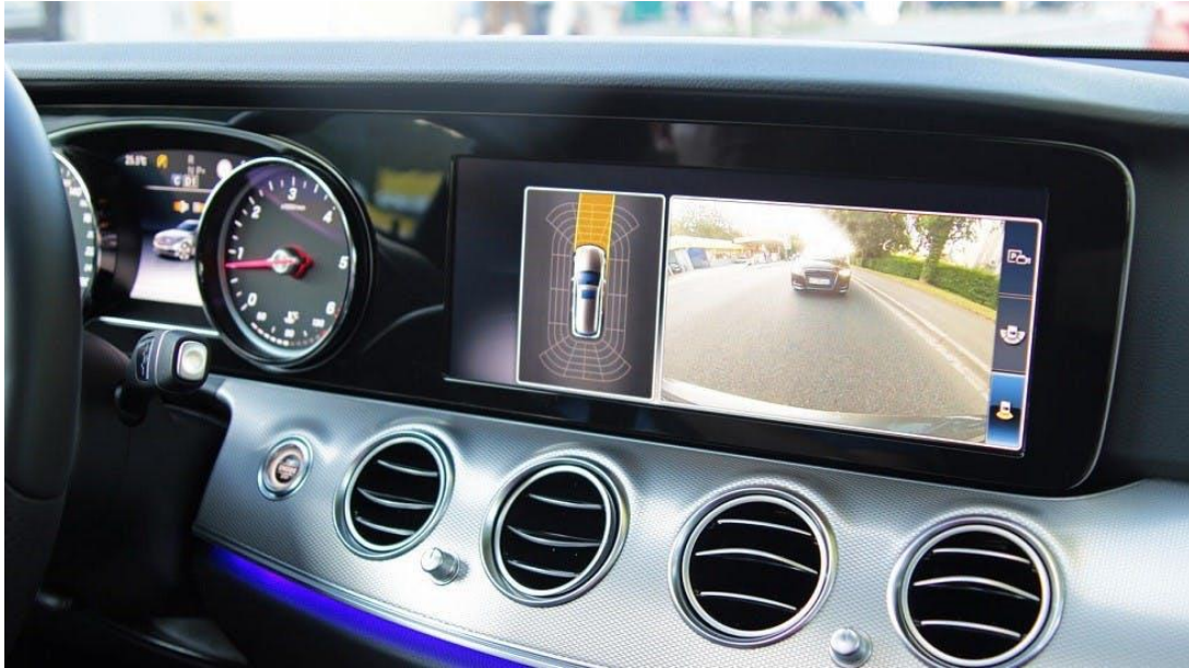
Figure 1 - caméra de recul qui permet aux conducteurs de reculer en toute sécurité [8]
