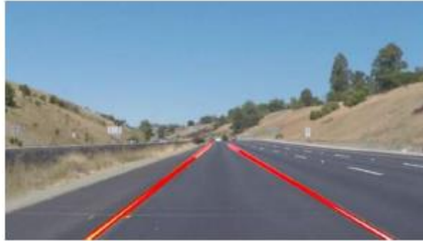
Figure 13 - Transformation de Hough pour la détection des lignes de voie [56]
