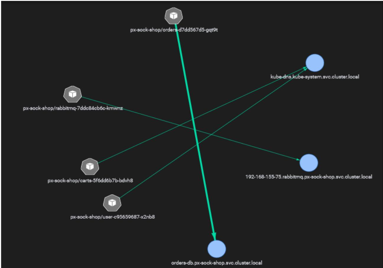
FIG. 4.2 : Graphe qui montre la communication entre les pods de l'espace de nom px-sock-shop
