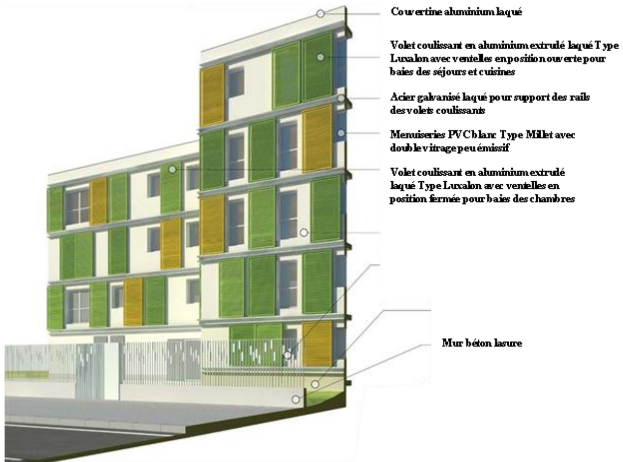
Figure 11 Façade et coupe avec détail technique
