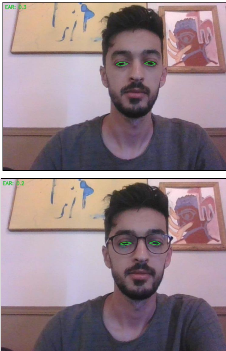
Figure 13 - Détection des contours des yeux
