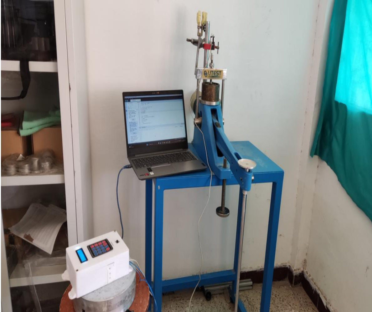
Figure 16 : l'appareil oedométrique avec le dispositif proposé
