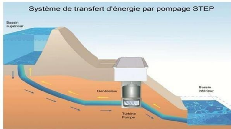
Figure1.3 Système de transfert d'énergie par pompage STEP [9]
