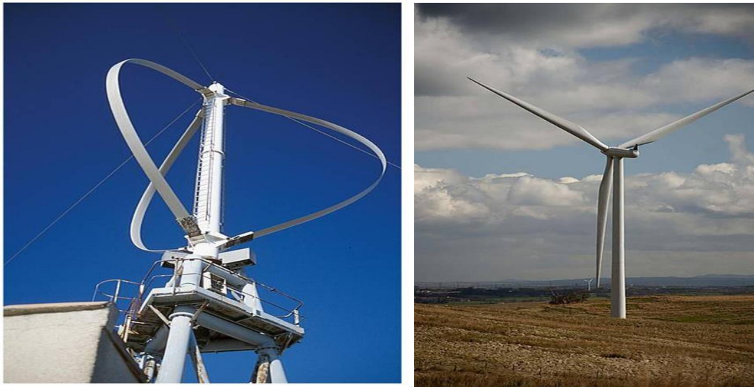
Figure. 1.7 : Eolienne à axe vertical (a) et axe horizontal (b)
