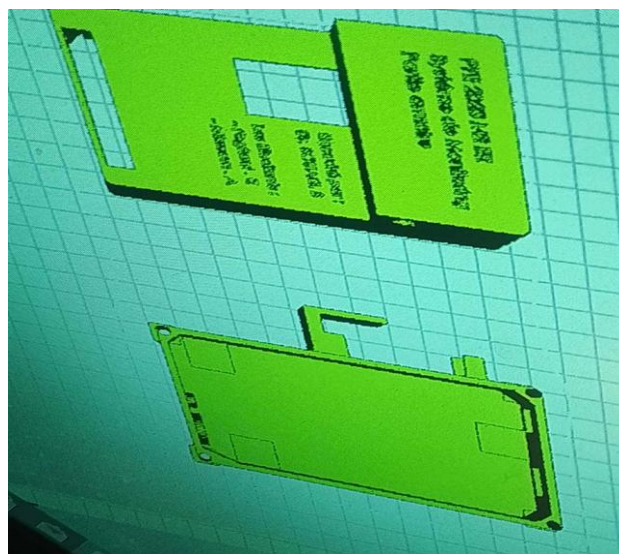
Figure VI.9 : L'importation des parties du modèle 3D en format STL sur l'imprimante 3D
