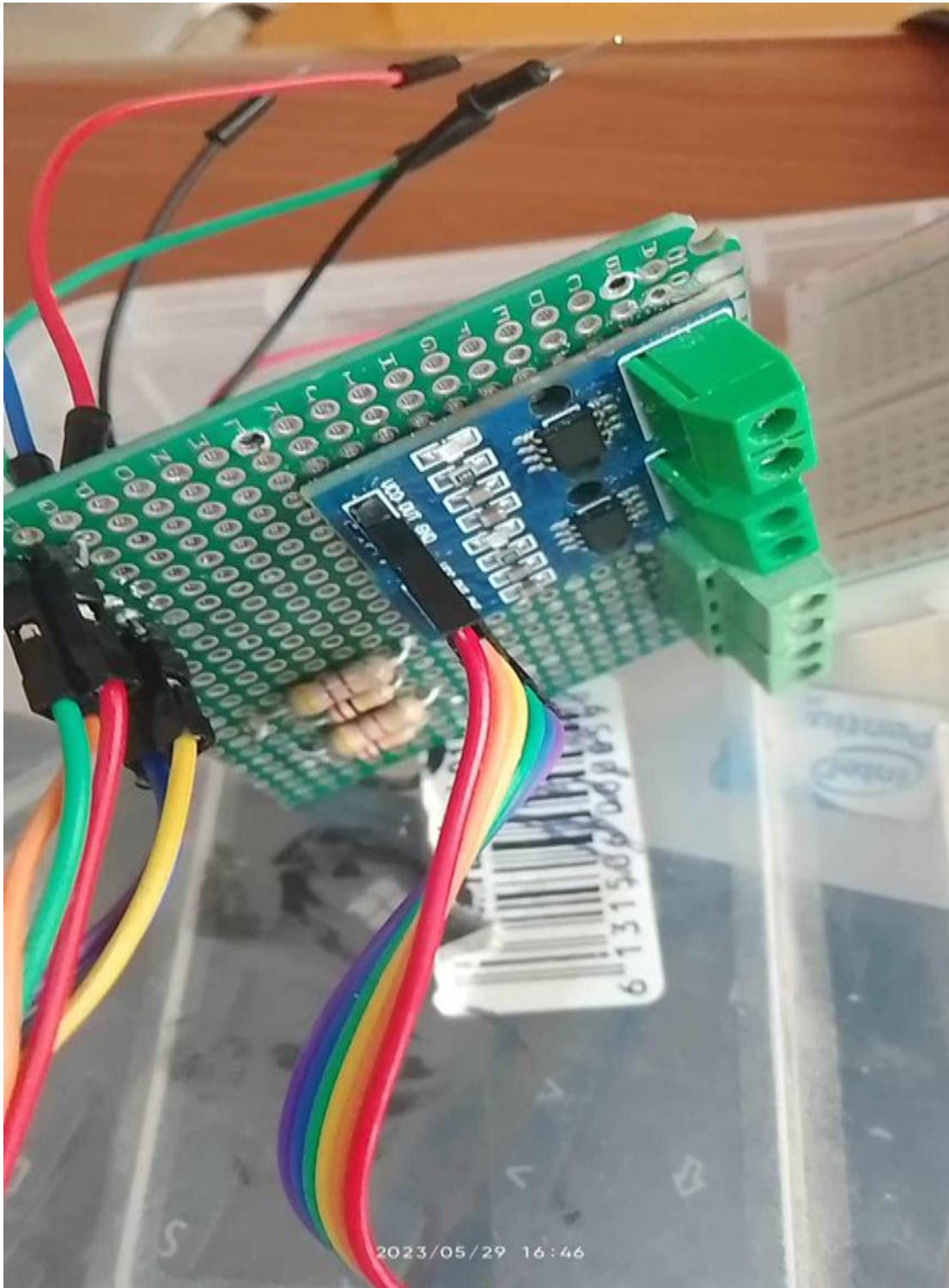
Figure VI.7 : Assemble les capteurs sur plaque de soudeur
