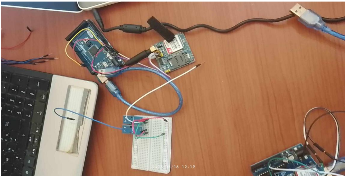
Figure VI.4 : Bloc test capteur sur plaque d'essai
