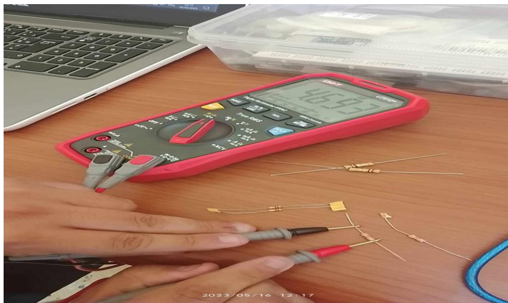
Figure VI.6 : Mesurer les résistances par le multimètre
