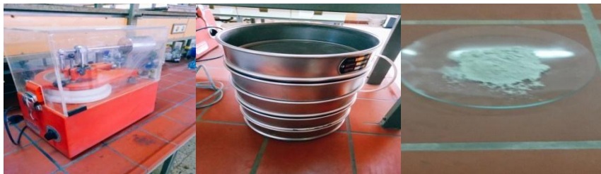
Figure II.2. Préparation de l'argile: broyage et tamisage
