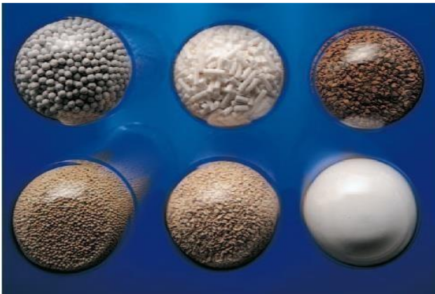
Figure II.3 : Tamis moléculaire sous ses différentes formes
