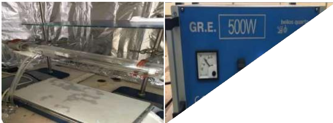
Figure 9: Le réacteur photocatalytique doté de sa lampe UV.
