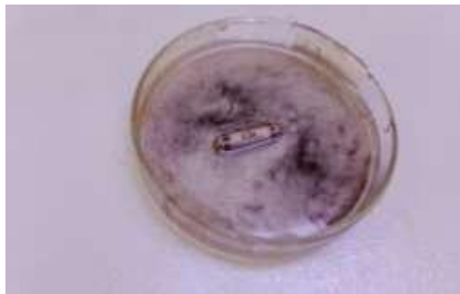
Figure 22 :Décoloration du l'AG25 par le couplage du \text{AlFe}_2\text{O}_4/\text{rGO} et KPS dans le soleil UV.
