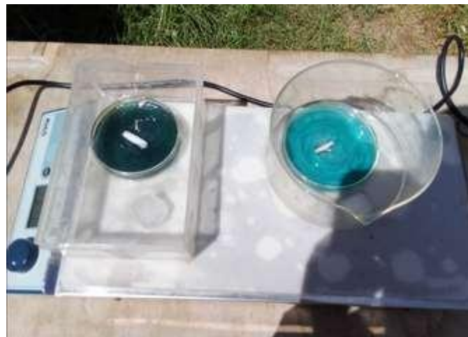
Figure 16: Etude de la photocatalyse du nano- \text{AlFe}_2\text{O}_4/\text{RGO} avec l'AG25 dans le soleil-UV
