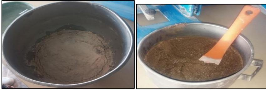
**Figure(III.17):** mélange de mortier géopolymère
