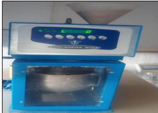
**Figure (III.18) :** malaxeur à mortier
