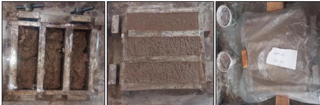
**Figure(III.19) :** moulage du mortier géopolymère
