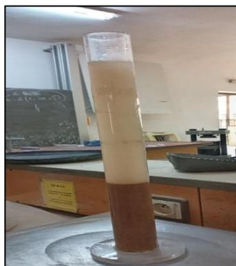
**Figure(III.11)** : Essai d'équivalent de sable
