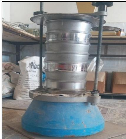
Figure (III.12) : appareillage pour essai granulométrie de sable
