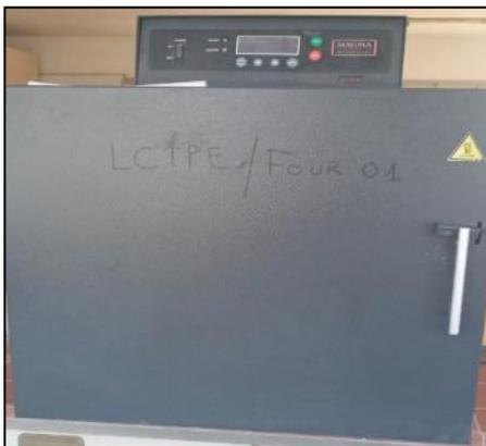
**Figure(III.8)** : four de calcination
