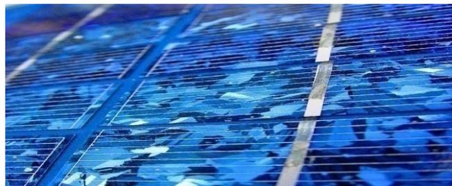
Figure 1.11: Cellule PV à base de silicium polycristallin
