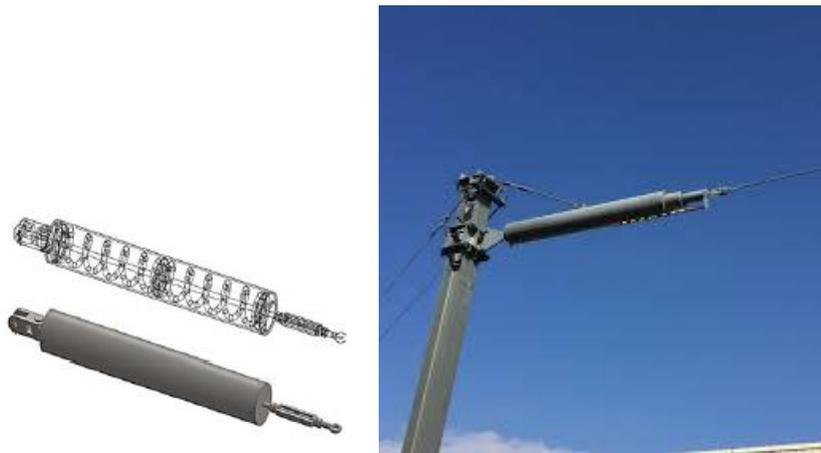
Figure III.14 : appareil tendeur à ressort [15]
