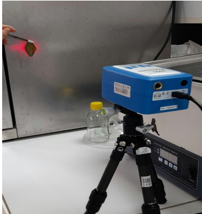
Figure 3.3 : L'appareil JETI Spectral 1501 pendant la prise des mesures dans le laboratoire de recherche « protection des végétaux » sis Ex. INES.
