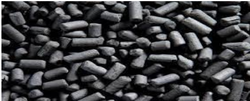
Figure II- 1 : Le charbon actif extrudé.
