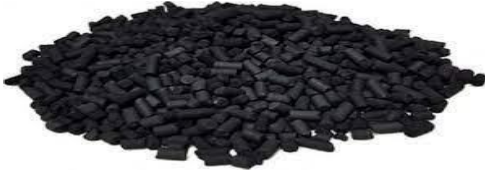
Figure II- 3 : Charbon actif granulé.
