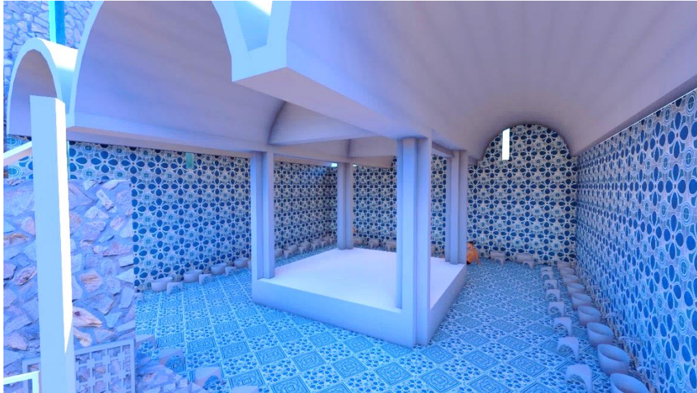
Figure 72 La configuration de coupole et les voutes dans la salle chaude -Source Auteurs
