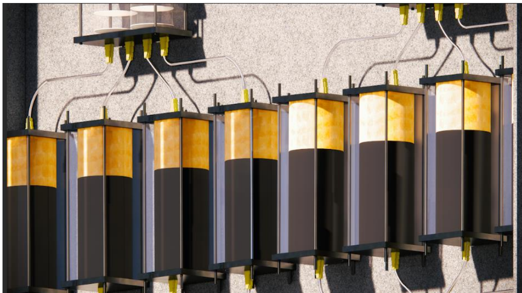
Figure 86 Phase 2 de filtration (filtres géotextile et à sable) Source : Auteurs
