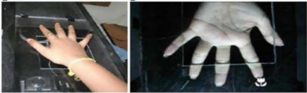
**Figure 2.10** Le dispositif d'acquisition CCD bidimensionnel à base contact
