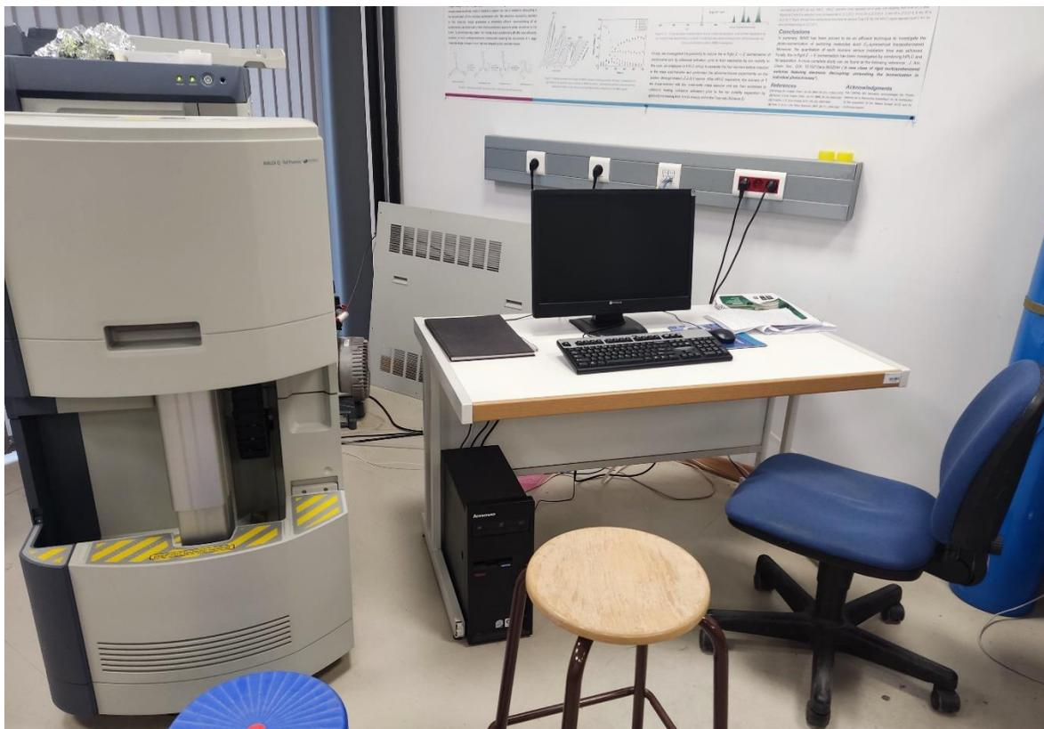
**Figure 34:** Spectromètre de masse Waters Q-ToF premier du laboratoire de Synthèse et Spectrométrie de Masse Organiques (S<sup>2</sup>MOs).
