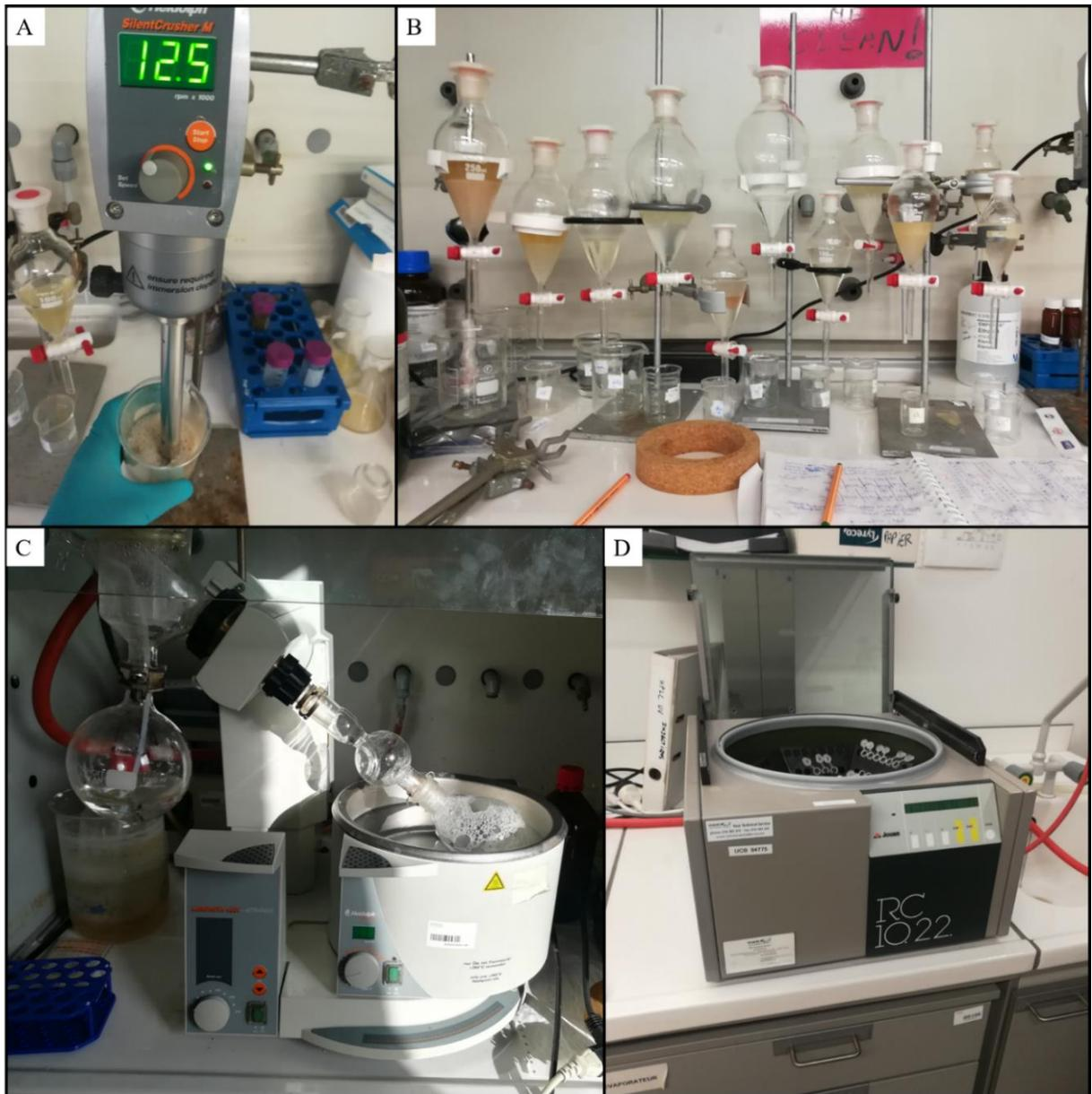
**Figure 31:** A. Broyage des échantillons. B. Séparations densitométriques. C. Roto-évaporation avec la formation de mousse. D. Séchage des extraits butanoliques au speed Vac Jouan RC 10.22.
