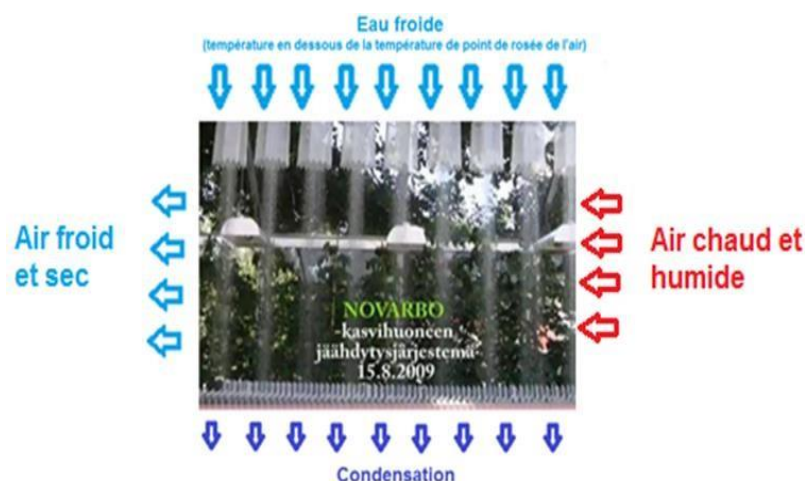
Figure VI. 6. Représentation générale de la méthode de R/D par rideau d'eau [158].
