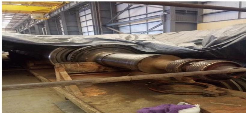
**Figure I. 16** vue externe rotor de l'alternateur du central de Marsat el hadjadj
