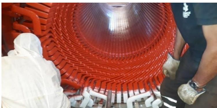
**Figure I. 15**vue externe stator de l'alternateur du central de Marsat el hadjadj
