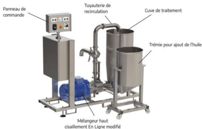
Figure 6. Schéma simplifié pour la production industrielle de la mayonnaise en mode discontinu
