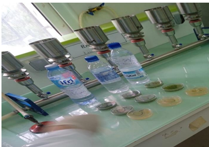
Figure26 : L'appareil de filtration sur membrane.
