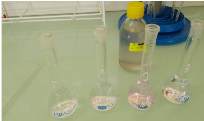
Figure21 : dosage de nitrite \text{NO}_2^- .
