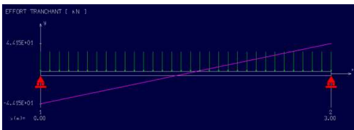
Figure IV.9: Diagramme de l'effort tranchant à l'ELU
