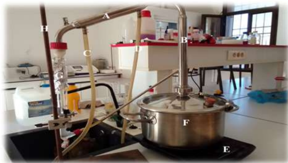
Figure 18 : Composants de distillation à la vapeur ;A: réfrigérant, B: condensateur, C: entrée de l'eau, D: sortie de l'eau, E: plaque chauffante, F: cocotte-minute et G: tube gradué (Originale, 2023)
