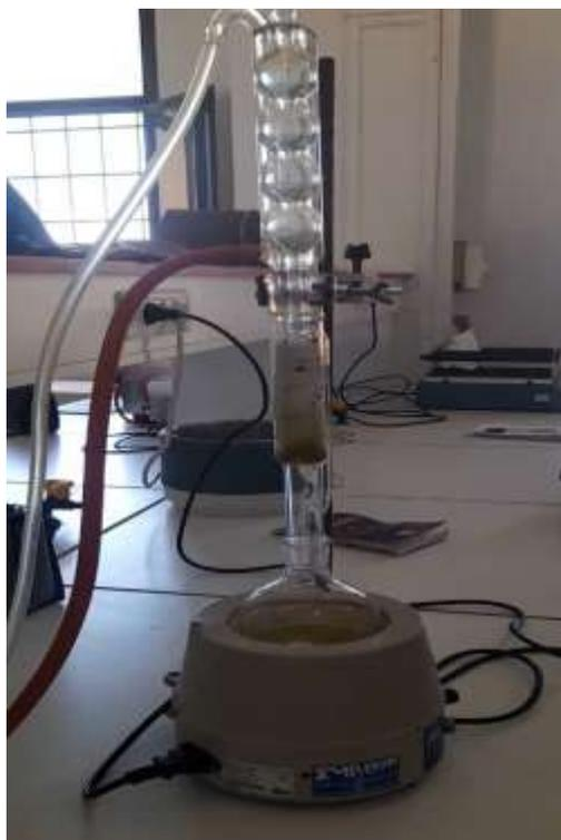
**Figure 6** : Appareillage utilisé pour l'extracteur Soxhlet (original, 2023).
