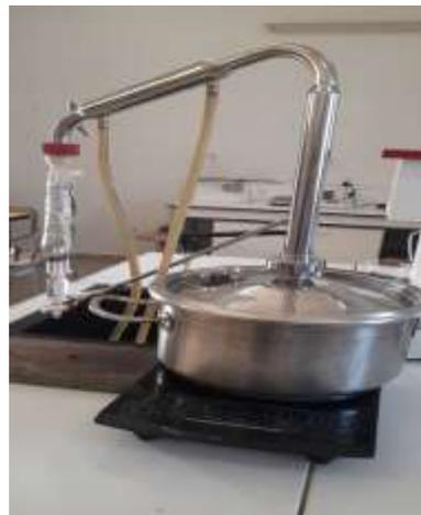
**Figure 10** : Extraction par entraînement à la vapeur (original. 2023).
