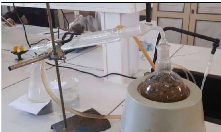
**Figure 5** : Appareillage utilisé pour l'hydro distillation (original,2023).
