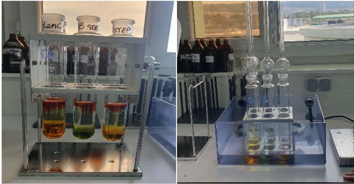
Figure N°19 : Titrer l'excès \text{dek}_2\text{Cr}_{207} . Figure N° 20 : Refroidissement dans impact.
