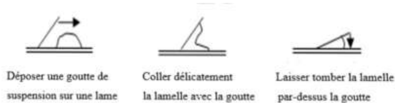
Figure 13: Etapes de préparation d'une lame d'examen à l'état frais. (Benaissa.A 2020)
