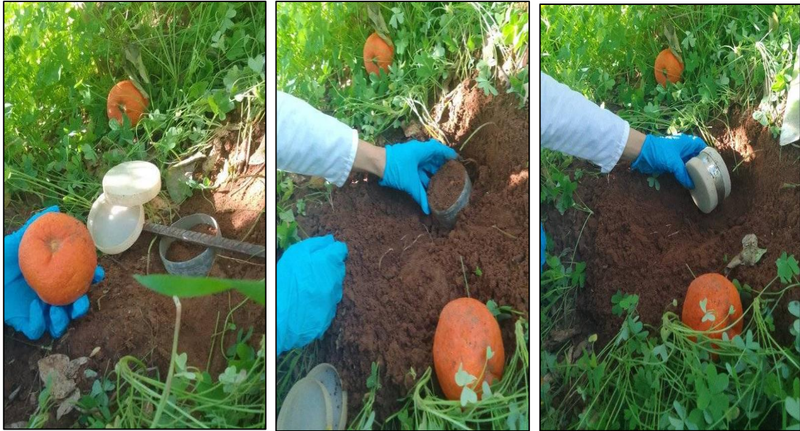
Photo 3: Mesure de la densité apparente à l'aide du cylindre (Cliché Benharira et El Kbaili, 2023).
