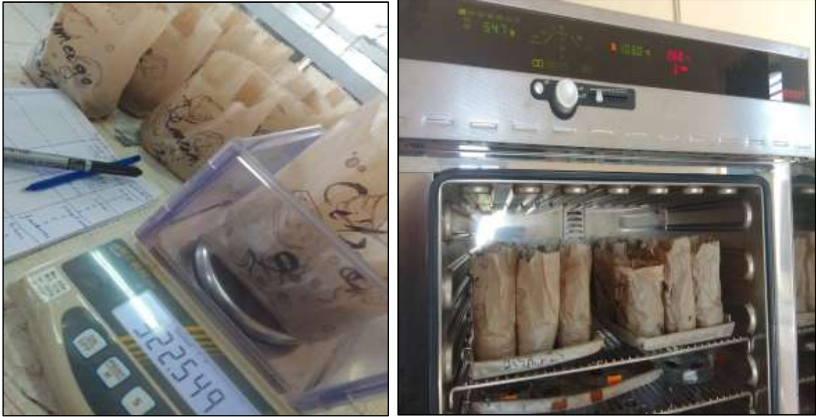
Photo 2: Échantillons de sol pesés et séchés à l'étuve ( Photo originale, 2023 ).
