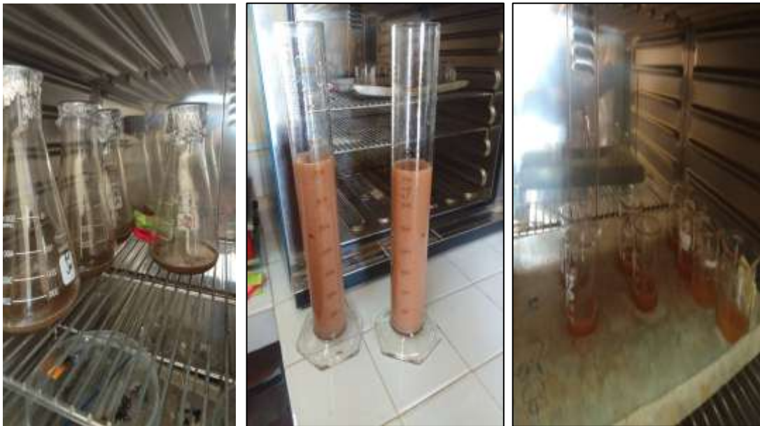
Photo 6: Analyse granulométrique par la méthode de la pipette (Photo originale, 2023).
