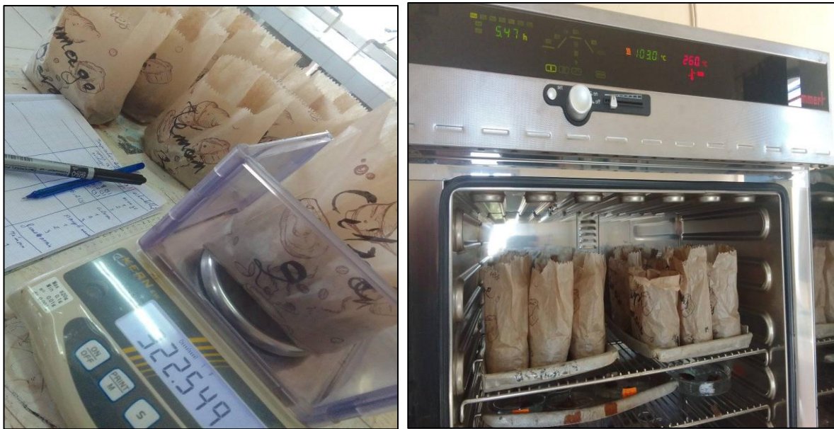
Photo 2: Échantillons de sol pesés et séchés à l'étuve ( Cliché Benharira et El Kbaili, 2023 ).
