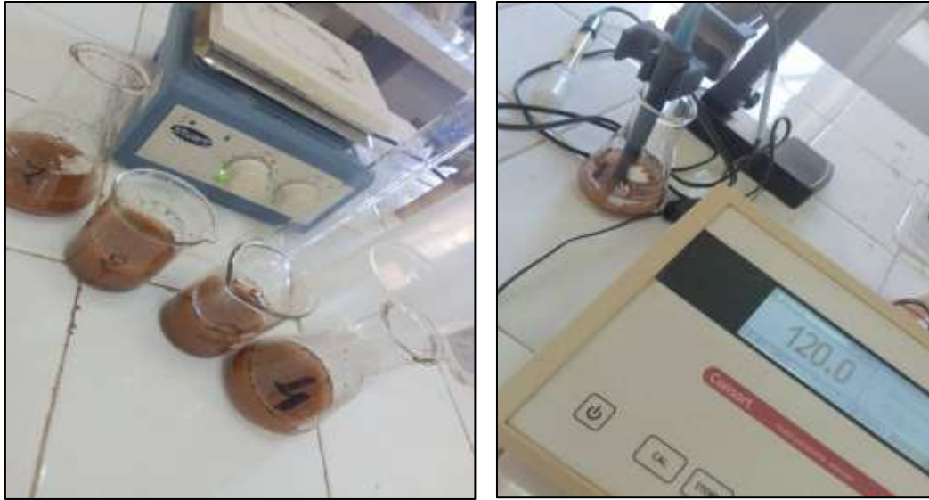
Photo 8 : Mesure de la conductivité électrique du sol par le conductimètre (Photo originale, 2023).
