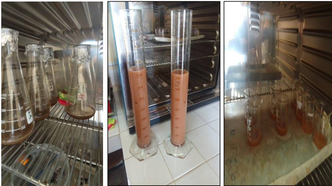
Photo 6: Analyse granulométrique par la méthode de la pipette (Cliché Benharira et El Kbaili, 2023).
