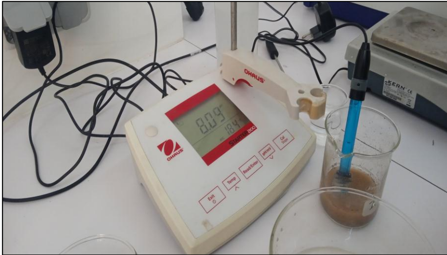
Photo 7: Mesure du pH d'un échantillon de sol à l'aide d'un pH mètre (Cliché Benharira et El Kbaili, 2023).
