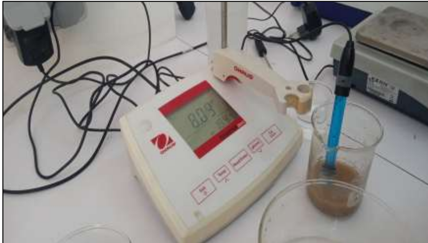
Photo 7: Mesure du pH d'un échantillon de sol à l'aide d'un pH mètre (Photo originale, 2023).
