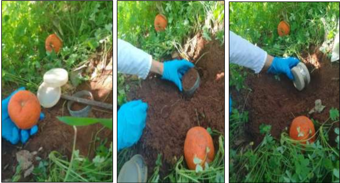
Photo 3: Mesure de la densité apparente à l'aide du cylindre ( Photo originale, 2023 ).
