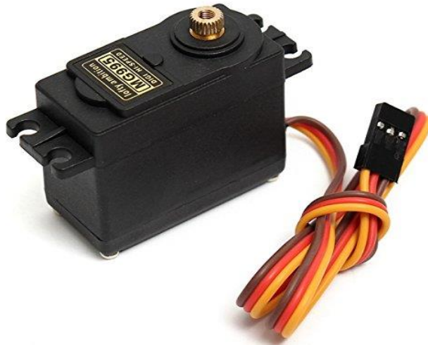
Figure I-6- Série de servomoteurs MG995 6
