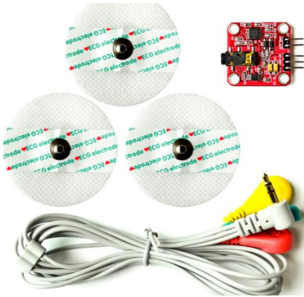
Figure I-4- Sonde EMG utilisée 4
