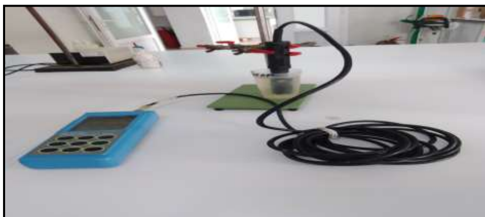
Figure N°9: Détermination de l'oxygène dissous par oxymétrie (Photo originale, 2023).
