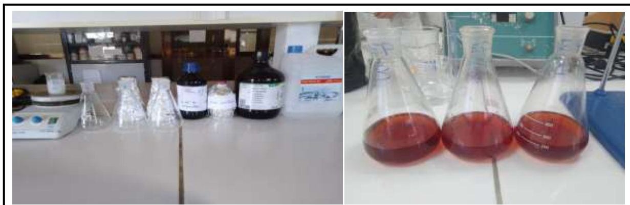
Figure N°19: Détermination de l'indice d'iode ( Photos originales , 2023)
