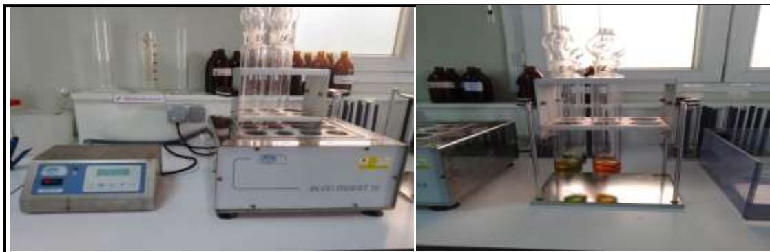
Figure N°8: Détermination de DCO (Photos originales, 2023).
