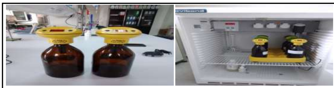
Figure N°7: Détermination de DBO5 (Photos originales, 2023).
