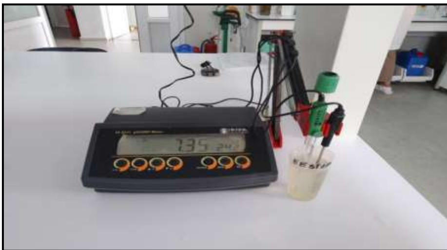
Figure N°4: Détermination de pH par pH-mètre ( Photo originale, 2023 ).
