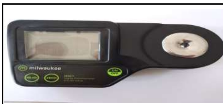
Figure N°21: Détermination de l'indice de réfraction par réfractomètre (Photo originale, 2023).
