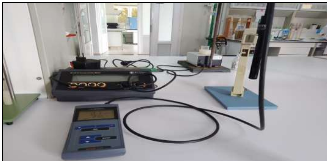
Figure N°10: Mesure de la conductivité électrique par conductimètre (Photo originale, 2023).
