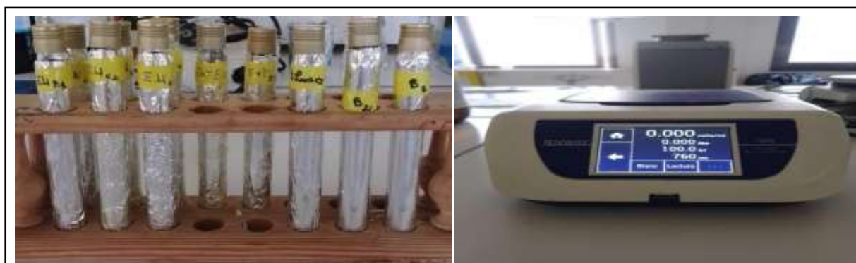
Figure N°24: Dosage de polyphénols à longueur d'onde 760nm (photos originales, 2023) (Annexe N°15).
