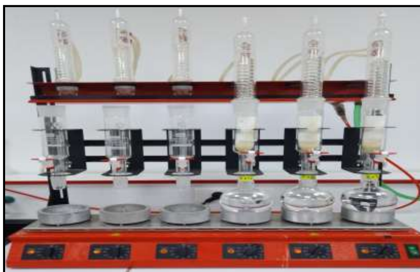
Figure N°30: Détermination la teneur en corps gras par méthode de Soxhlet (photo originale, 2023).
