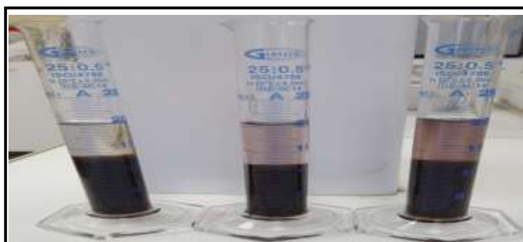
Figure N°20: Détermination de l'indice de siccativité ( Photo originale , 2023).
