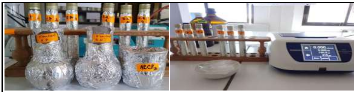
Figure N°26: Extraction et dosage de flavonoïdes à longueur d'onde 415nm ( Photos originales, 2023 ) (Annexe N°16).
