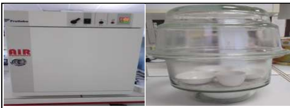
Figure N°29: Détermination de taux d'humidité à 103°C et refroidissement au dessiccateur (photos originales, 2023).
