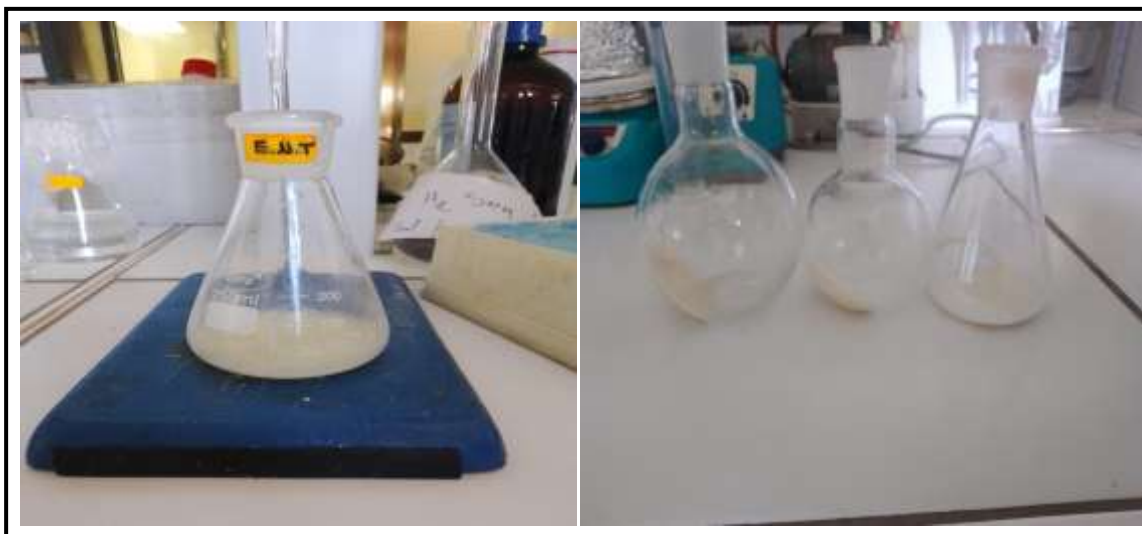
Figure N°17: Détermination de l'indice de saponification ( Photos originales , 2023).
