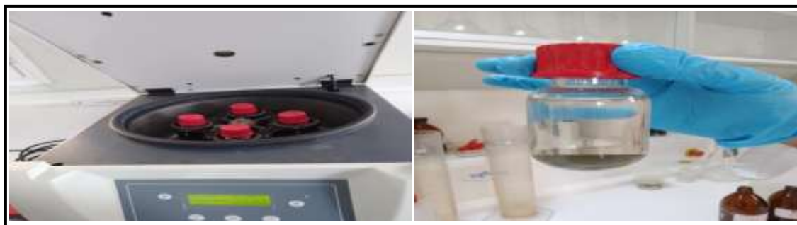
Figure N°6: Détermination de MES par centrifugation (Photos originales, 2023).
