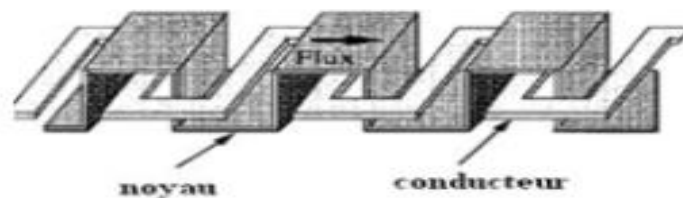
Figure I-13 Inductance méandre intégrée avec deux niveaux de matériau magnétique [C.2]
