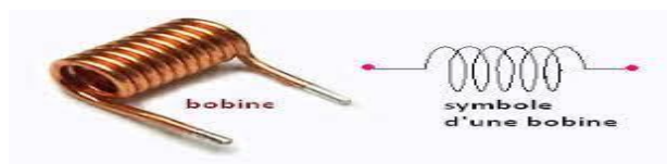
Figure I-4 Shema d'une bobine discret
