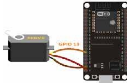
Figure III. 7 schéma électrique du servo
