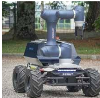
Figure I. 9 Le robot mobile avec bras robotique.
