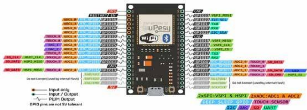
Figure II. 1 Brochage de la carte d'ESP32
