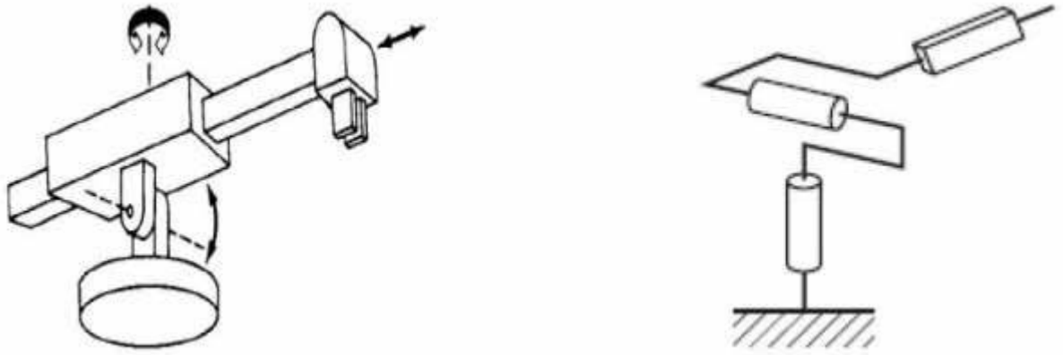
Figure I. 13 Structure d'un robot sphérique
