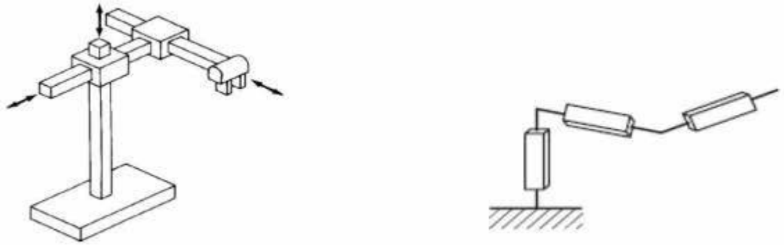
Figure I. 11 Structure d'un robot cartésien
