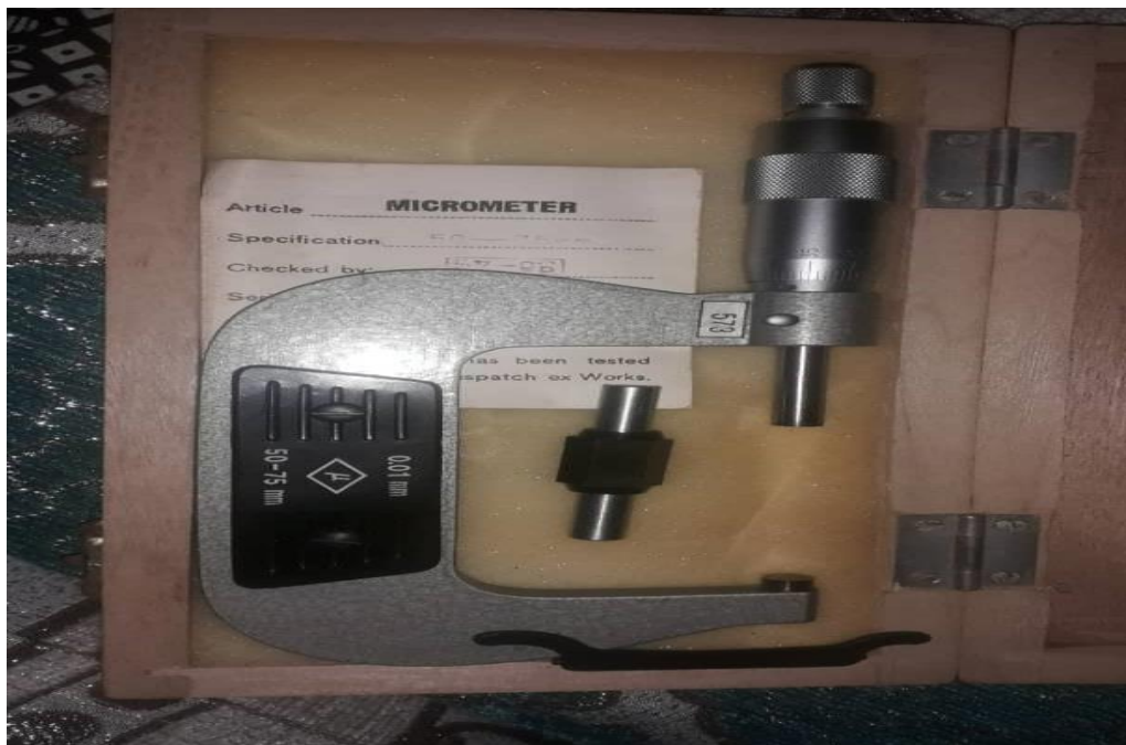
Figure 45: micromètre utilisé pour les mesures de diamètres de fruits ( Aicha, 2023 )
