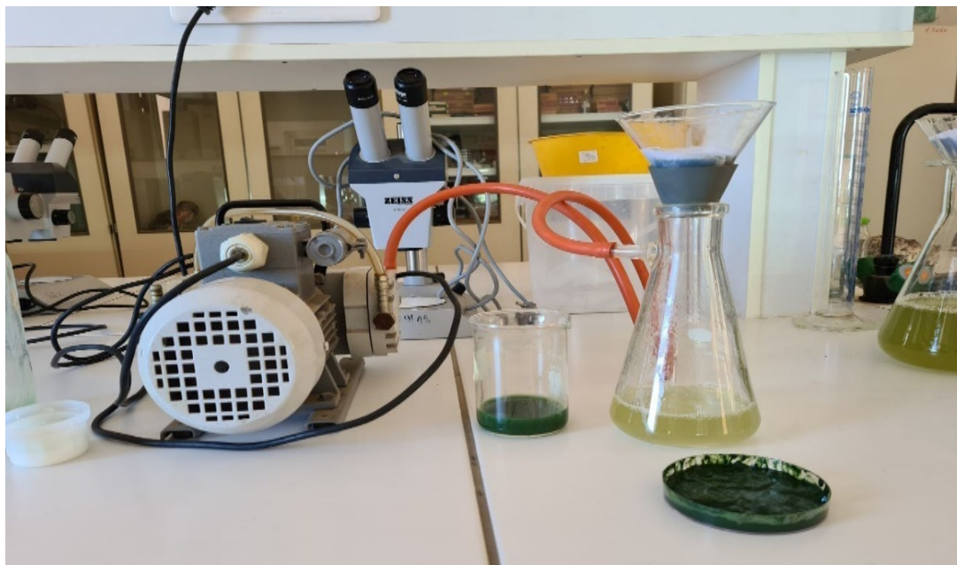
Figure 23. Dispositif de filtration à vide
