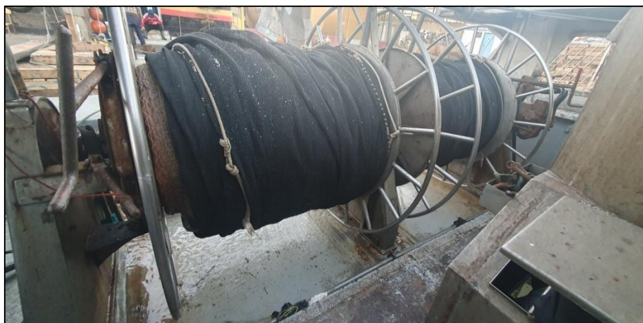
Figure 16: Le filet de pêche rassemblé à l'arrière d'un chalutier (Présent travail).
