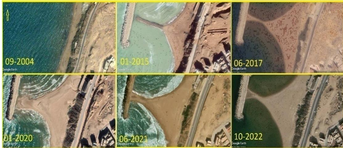
**Figure 18:** Photos satellitaire de Google-earth montrant les modifications de trait de côte entre 2004 avant la construction de digue et 2022 au niveau de la page de Sidi-mejdoub.
