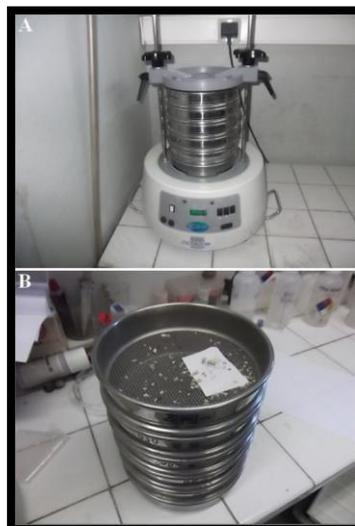
**Figure 6:** Série de tamis superposés (norme AFNOR, de 63  $\mu\text{m}$  à 2 mm)
