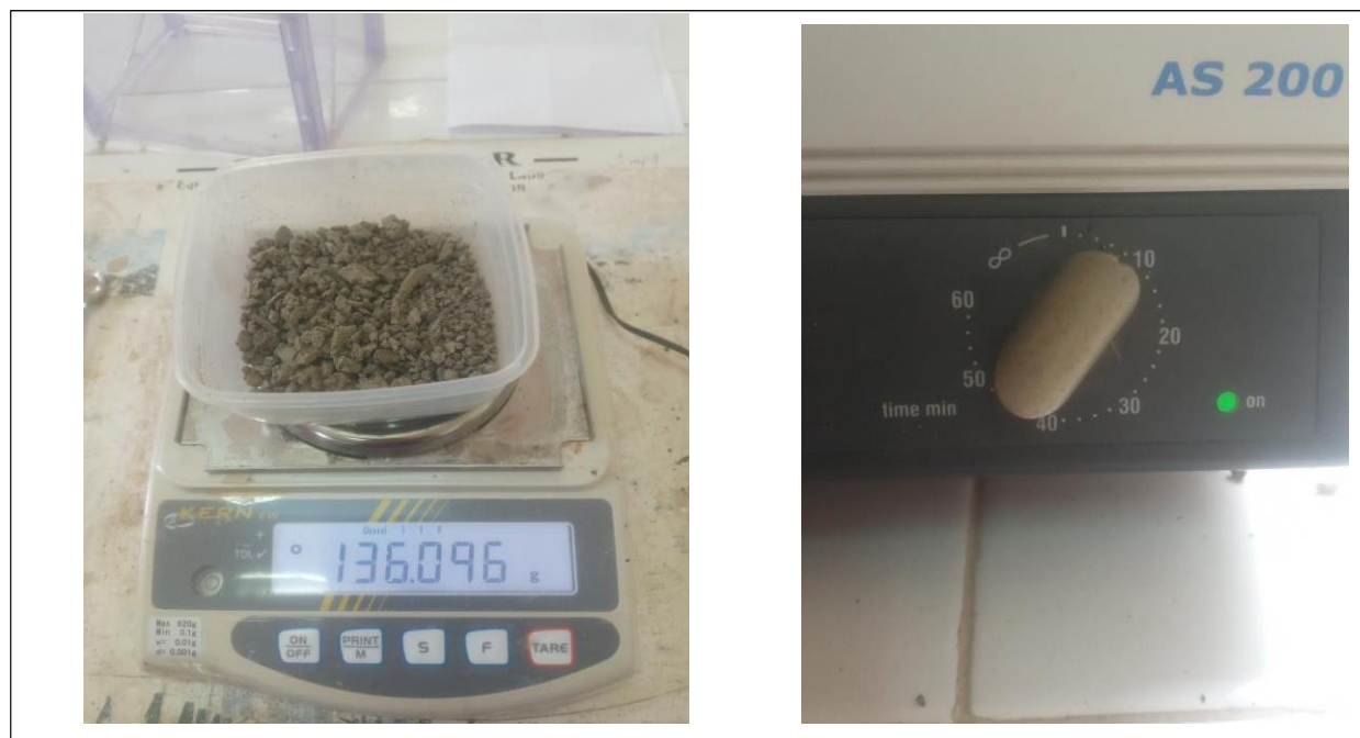
Figure 50 : Mesure de poids de tamisage de chaque calibre et le Temps de tamisage sélectionné à 10 min (originale)
