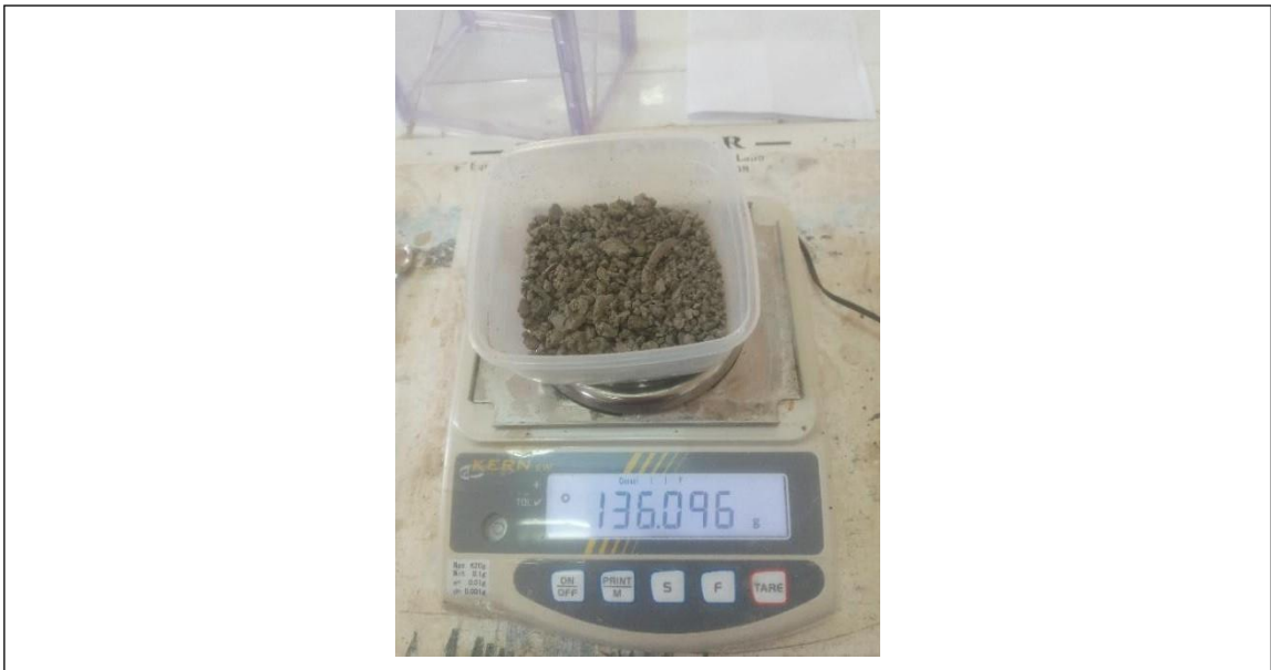
Figure 46 : Mesure de poids d'un échantillon de sol argileux (originale)
