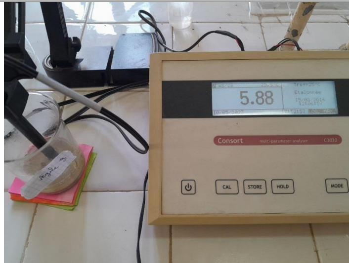
Figure 55 : Mesure de conductivité électrique (originale)
