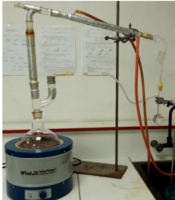
Figure 9 : Le dispositif de l'hydrodistillation ( Clevenger ). ( photo originale )
