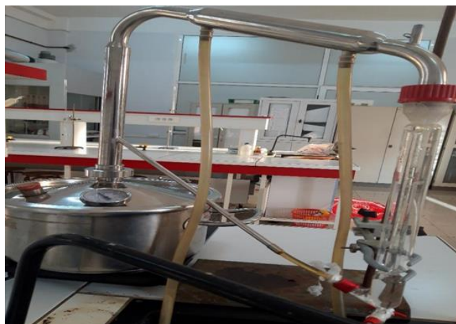
Figure 8 : Hydrodistillation par Entraînement de la vapeur (photo original)
