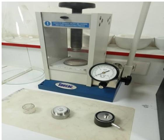
**Figure 18 :** presse hydraulique permettant d'obtenir une pastille
