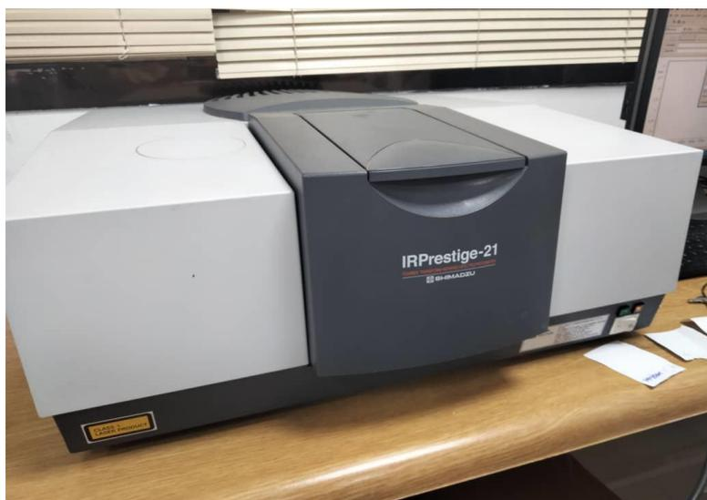
**Figure 19 :** Spectrophotomètre infrarouge à transformée de Fourier IRTF
