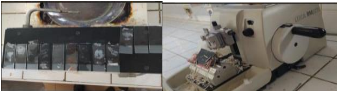
Figure 19 : la coupe au microtome manuel
