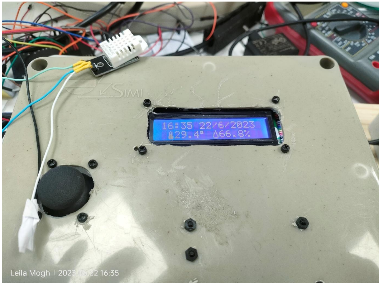
Figure 55 Surveillance de température et humidité à l'aide LCD
