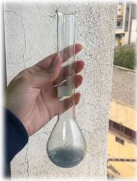
Figure 50 : Matra contient (l'échantillon + acide sulfurique + catalyseur)
