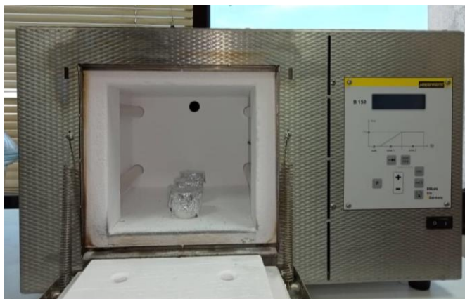
Figure 17: Incinération du tégument sec d' H. tubulosa dans un four à moufle à 600°C pendant 6 h.
