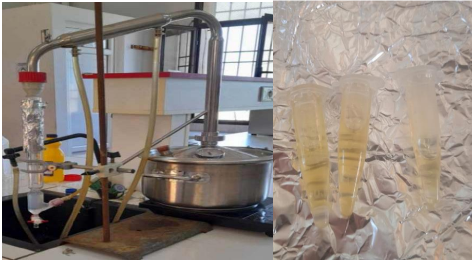
Figure 12 : Un appareil d'extraction d'huiles essentielles, un deuxième type de distillation à la vapeur
