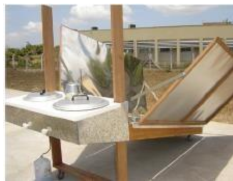
Figure 17. Les cuisseurs solaires à capteurs en verre plat.
