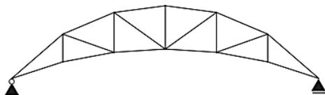
Les poutres à membrures non parallèles sont conçues pour optimiser la répartition des matériaux en fonction des charges. Elles peuvent avoir des membrures de profils différents, l'une en compression et l'autre en traction, pour maximiser la performance en fonction de la situation.
