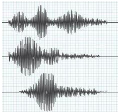
Les mouvements du sol se produisent dans trois directions distinctes et indépendantes. Par conséquent, pour étudier une construction en contexte sismique, il est nécessaire d'avoir trois accélérogrammes<sup>1</sup> (dans les directions x, y et z).
