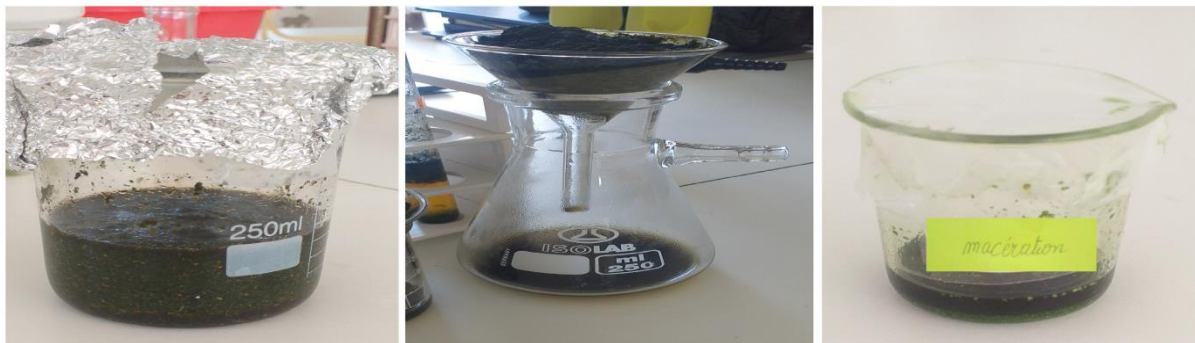
Figure 09 : Préparation de l'extrait aqueux par macération
