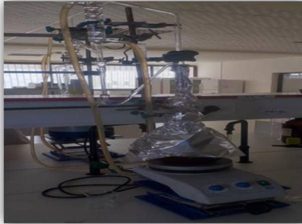
Figure 20 : Montage de Clevenger.
