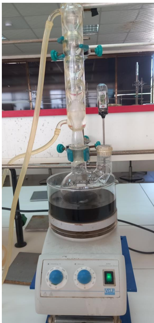
Figure 24. Montage à reflux.
