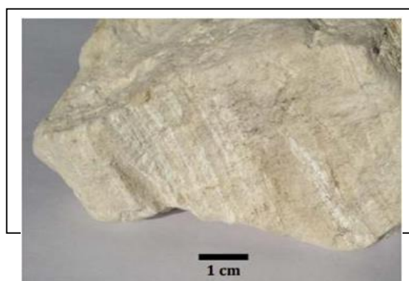
Figure I.1 : Photo d'un échantillon de diatomite de la mine de Sig [5].
