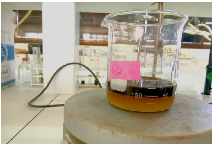
Figure II.16: Aspect de la solution avec les silicates de sodium R 2,4.
