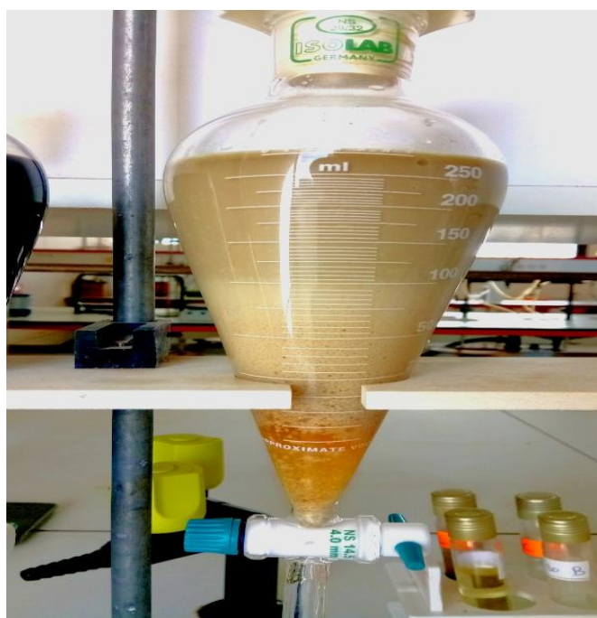
Figure II.9 : Décantation après la neutralisation.
